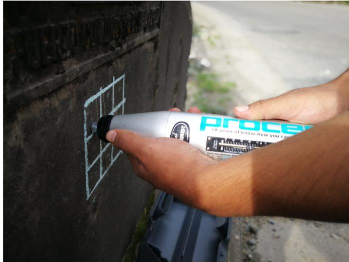
Fig. 3. Ensayo del esclerómetro.2.3.- Ensayos Destructivos
