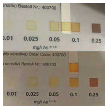
Figura 4 Resultados del test de arsénico del patrón inicial y el agua tratada respectivamente.
