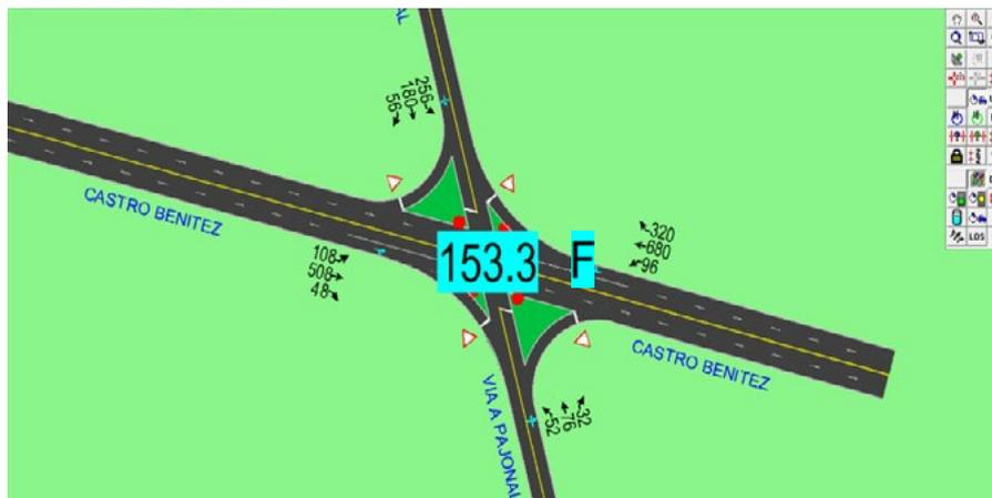
Figura 2. Tiempo de demora y nivel de servicio en la intersección
