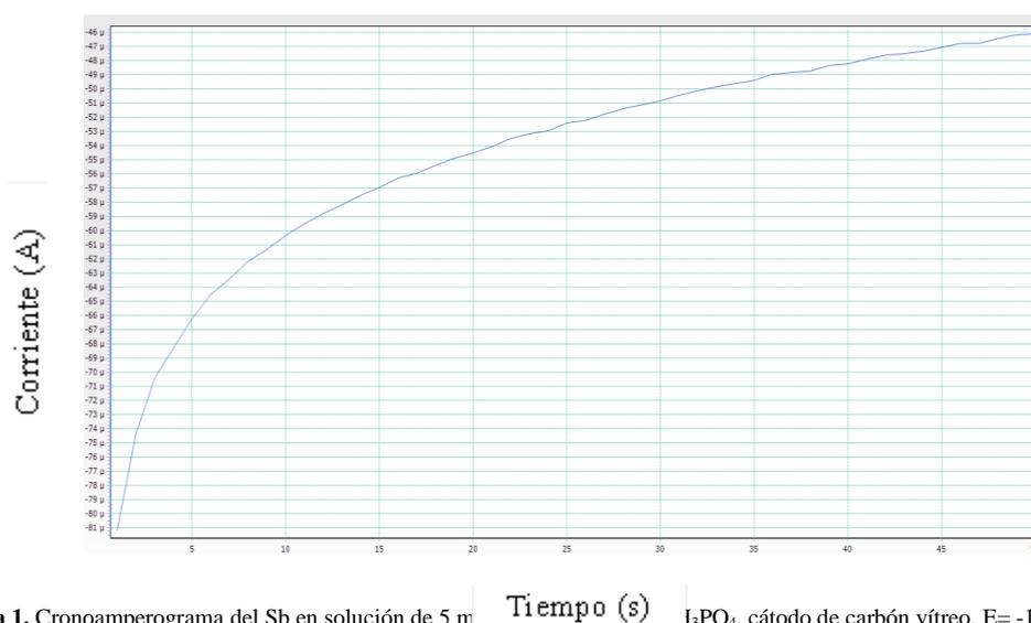
Figura 1. Cronoamperograma del Sb en solución de 5 ppm  $I_3PO_4$ , cátodo de carbón vítreo.  $E = -1.2$  V,  $t = 50$  s.
